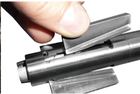
System mocowania "NC" Nie ma możliwości zgubienia dzięki zakotwiczeniu rozpiereków w trzpieniu
